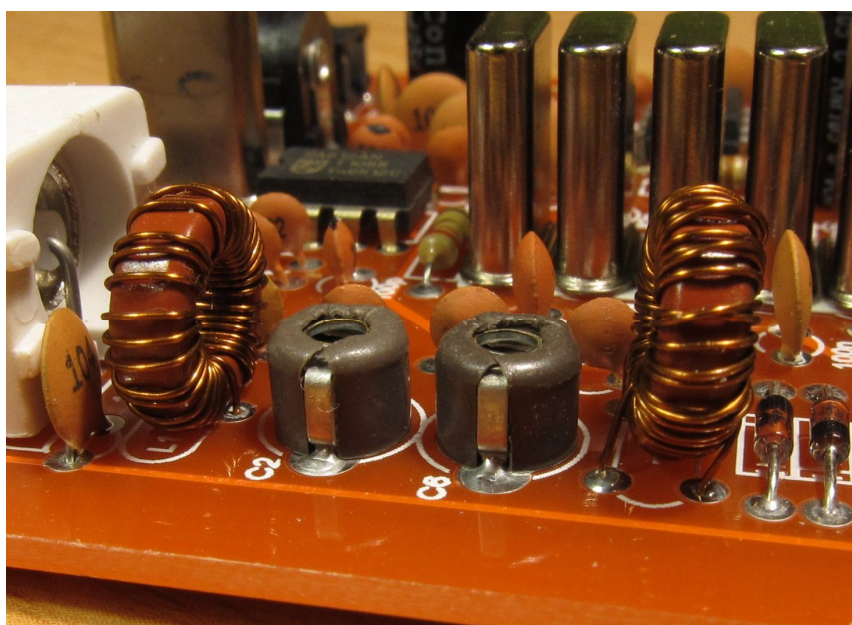
Sposób montażu trymerów w filtrze BPF
